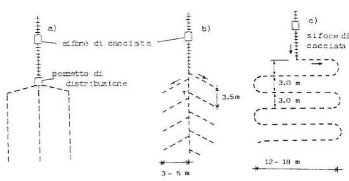
Fig. 3 - Disposizione delle condotte di sub-irrigazione
