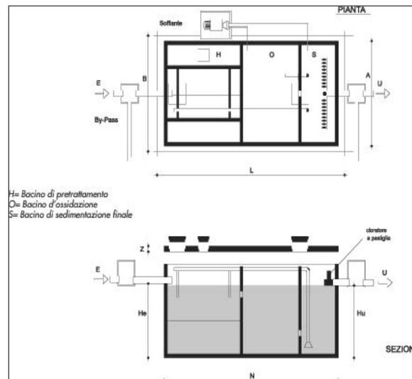
Fig. 10 – Impianto ad ossidazione totale
