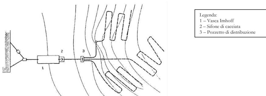
Fig. 2 - Andamento planimetrico delle condotte di sub-irrigazione
